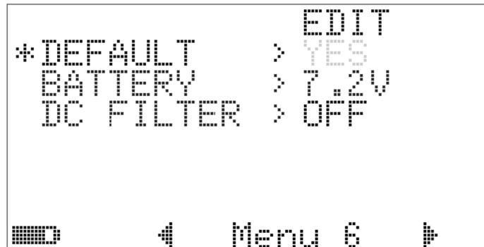
Figura 4-30 Retorno a la configuración de fábrica
