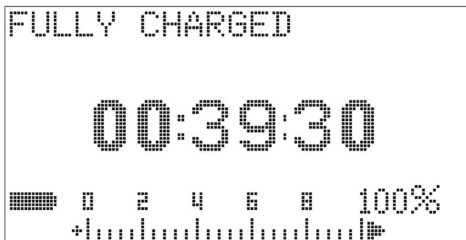
**Figura 5-5** Carga completa y en estado de goteo
